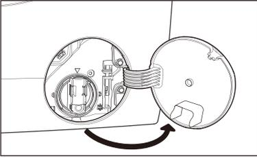
2. ضع وعاء ماء مناسباً أسفل تجويف مضخة التصريف لتجميع المياه المتدفقة للخارج.
