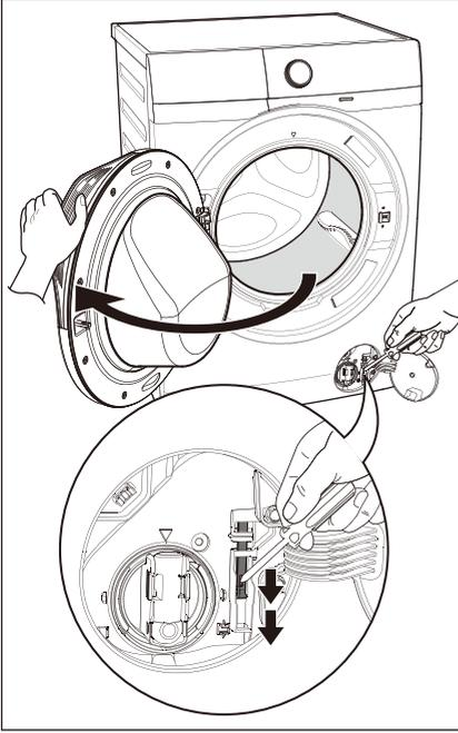
يظل باب الجهاز مغلقاً في حالة انقطاع التيار الكهربائي أو تعطل الجهاز. ويستأنف برنامج الغسل عند استعادة الطاقة. إذا ظل الباب مغلقاً في حالة حدوث عطل، فمن الممكن فتحه باستخدام ميزة إلغاء القفل في حالة الطوارئ.
