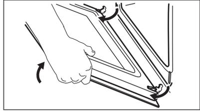
**Étape 4** Mettez la porte sur un chiffon doux sur une surface stable et relâchez le système de verrouillage pour retirer le panneau de verre interne.
